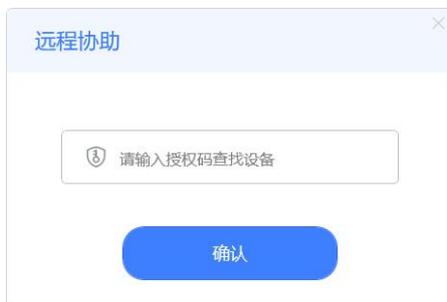
输入正确的授权码，确认后，设备自动添加到设备列表中。已授权的设备名称左侧会增加标识
